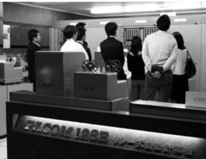
富士通沼津工場・池田記念室に現存する現役最古のコンピュータFACOM 128Bは1959年に製造されたもの。40畳ほどの広さに操作台や加減算装置、印刷記憶装置など21台が並ぶ
